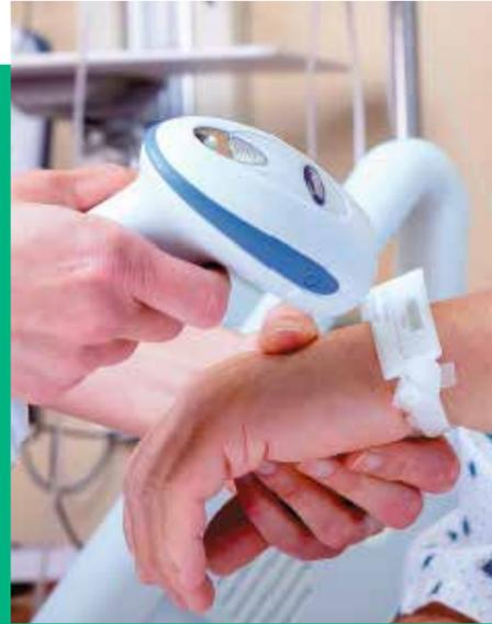
Beide Systeme werden ergänzt durch eine Barcode-Scan-Funktion, mit der Patient, Medikament oder Nährstofflösung sowie die entsprechende Pumpe erkannt werden. Die digitale Lösung eröffnet Möglichkeiten, Prozesse im Krankenhaus so zu vereinfachen, dass Pflegekräfte die notwendigen Informationen nur noch verifizieren müssen und mehrere Arbeitsschritte mithilfe des Systems zentral steuern können.
