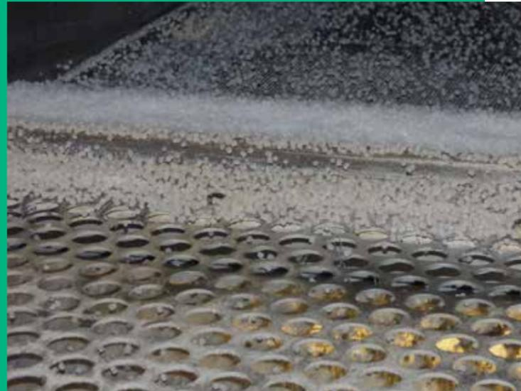
Regranulat und Neugranulat können in einem Verhältnis von 30:70 gemischt werden, ohne dass die Qualität des Endprodukts leidet. Entwickelt vom Center of Excellence Pharma in Melsungen, ist diese neue Technologie nun auch in Frankreich, Malaysia und Spanien etabliert worden. Das Verfahren sorgt für eine kosteneffiziente Produktion der Ecoflac-Behälter
