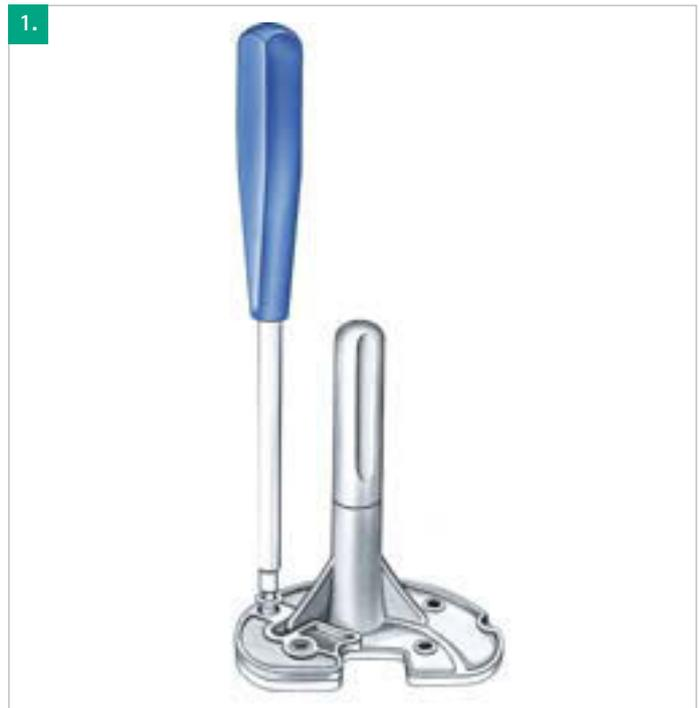
Im Anschluss wird der mit der Meniskus Komponente verpackte Rotationszapfen in das Plateau eingeschraubt und über einen auslösenden Drehmomentschlüssel und Adapter mit 10 Nm festgezogen. Als Gegenhalt kann das Tibia Probeplateau mit Universalhandgriff verwendet werden.
