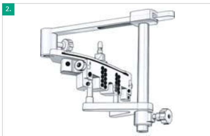
bietet der Revisions-Sägeblick Versetzmöglichkeiten für Stufenschnitte von 4, 8 oder 12 mm Höhe.
