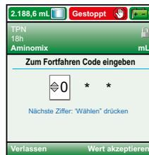
**Hinweis:** Wird die Meldung *Zum Fortfahren Schlüssel oder Code verwenden* angezeigt, können Sie die Tastatur mithilfe des Pumpenschlüssels oder mittels Eingabe des Admin-Codes (siehe oben) entsperren.
