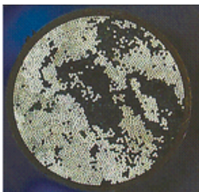
Rys. 2 Uszkodzone włókna światłowodu
