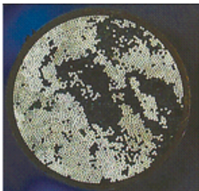
Рис. 2 Поврежденные оптические волокна
