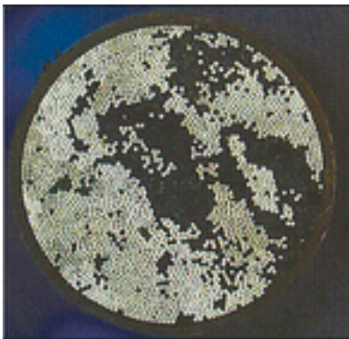
Fig. 2 Fibras del conductor de luz dañadas
