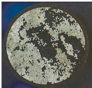
Fig. 2 Skadade optiska fibrer
