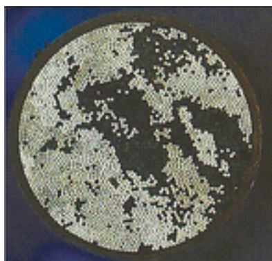
Fig. 2 Fibras óticas danificadas
