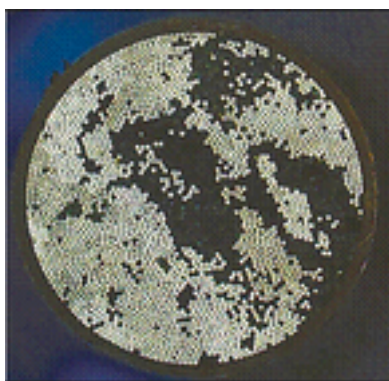
Fig. 2 Fibres optiques endommagées
