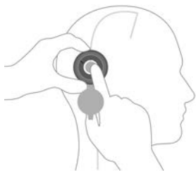
Fig. 11: Regulação com o M.blue plus Adjustment Ring
