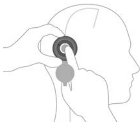
Fig. 11: Ajustage par la M.blue plus Adjustment Ring
