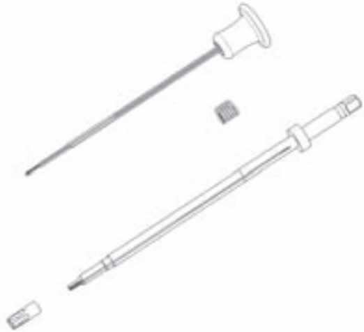
Abb. 10 Auseinandergezogene Darstellung des selbsthaltenden S 4 Cervical Schraubendrehers für Polyaxialschrauben
