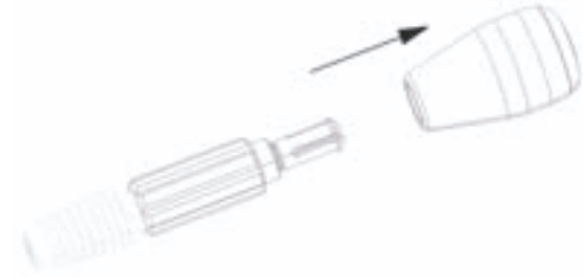
Şekil 8 Bükmeli delgi kolunun sökülmesi
