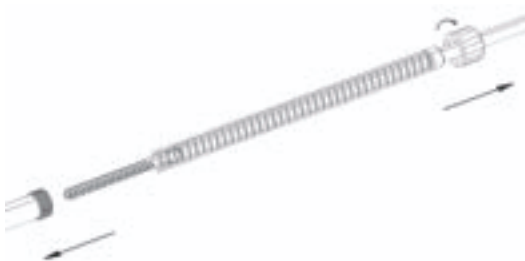
Afb. 9 Demontage van taps
