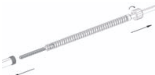
Fig. 9 Demontering av tappar
