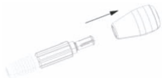
Рис. 8 Разборка рукоятки дрельбора
