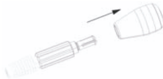
Obr. 8 Demontáž rukoväte špirálového vrtáčka
