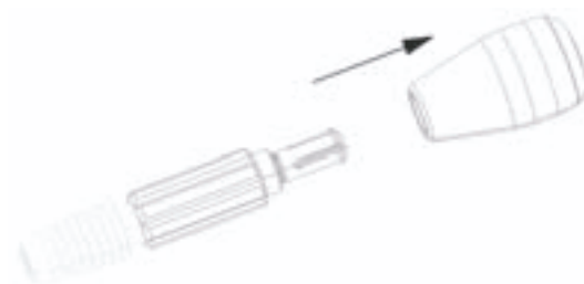
Fig. 8 Demontering av spiralborrshandtag
