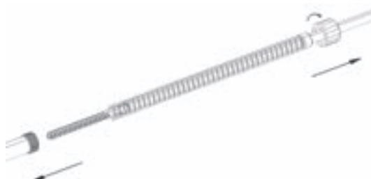
Fig. 9 Desmontagem de machos de parafusos
