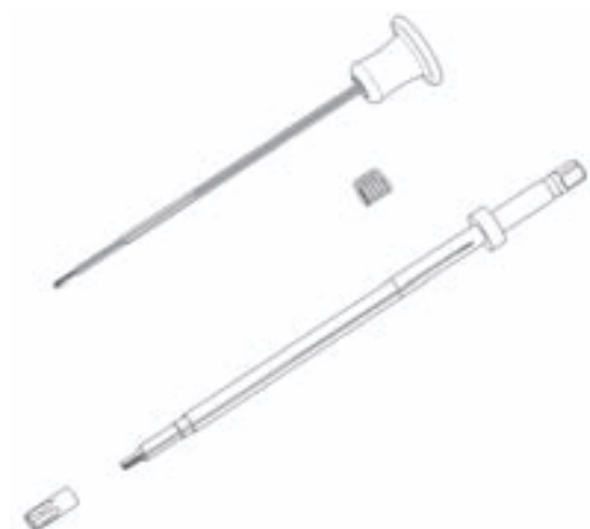
Fig. 10 Vue éclatée du tournevis polyaxial autobloqueur S 4 Cervical
