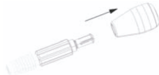
Fig. 8 Desmontaje del mango de broca
