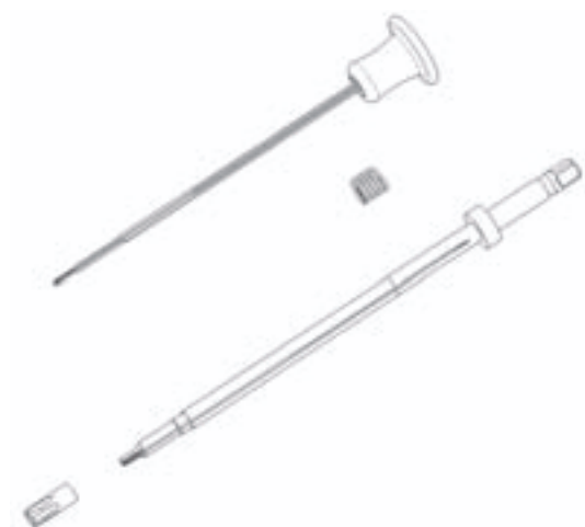
Obr. 10 Rozvinuté zobrazenie samodržiaceho polyaxiálneho skrutkovača S 4
