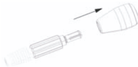
Afb. 8 Demontage van de draai-boorhandgreep
