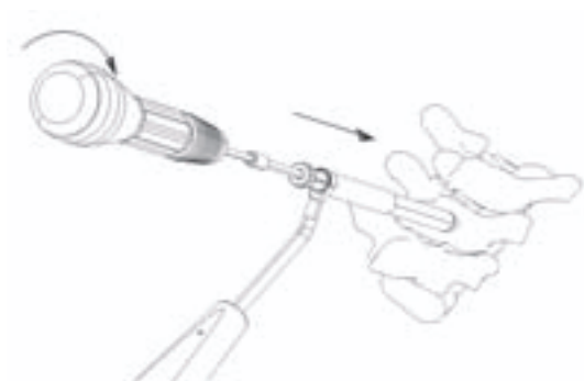
Obr. 4 Vrtanie s vodiacim vtákom (FW053R alebo FW049R)
