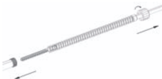
Fig. 9 Smontaggio dei maschi
