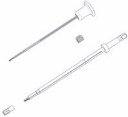
Şekil 10 S 4 Servikal kendinden tutmalı poliaksiyel tornavidanın genişletilmiş görünümü
