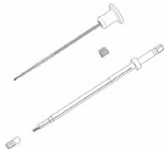
Fig. 10 Esploso del cacciavite poliassiale ad autotenuta cervicale S 4
