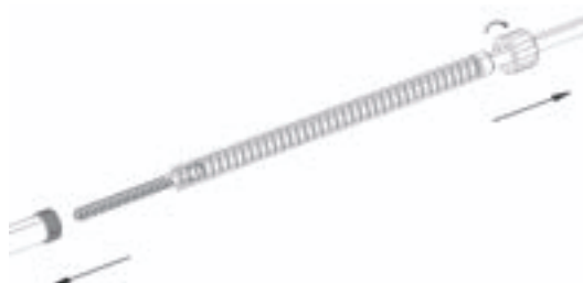
Fig. 9 Démontage des tarauds
