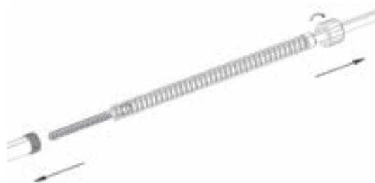
Fig. 9 Desmontaje de terraaja
