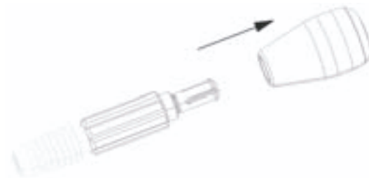
Abb. 8 Demontage des Bohrhandgriffs
