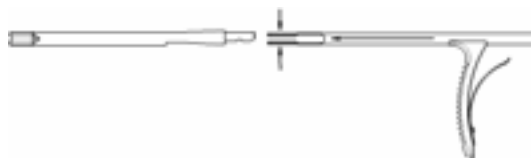
Рис. 13 Сборка устройства для вдавливания стержня
