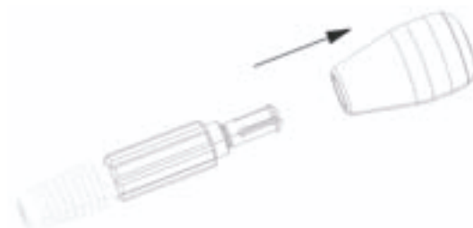
Fig. 8 Smontaggio dell'impugnatura punta a spirale
