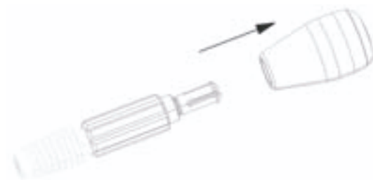
Fig. 8 Desmontagem do cabo de broca helicoidal
