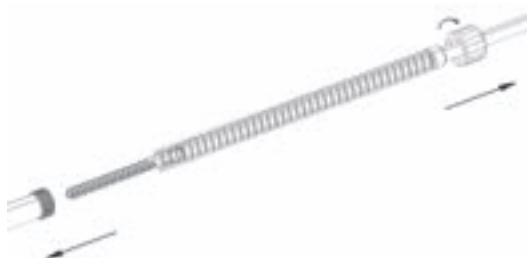
Abb. 9 Demontage von Gewindeschneidern
