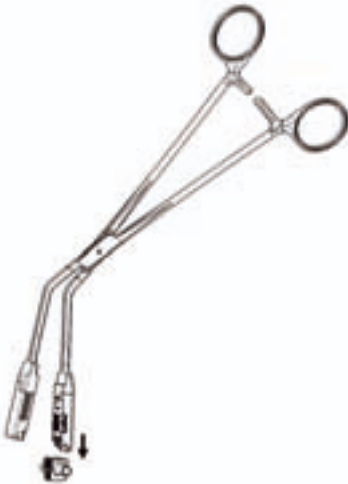
Fig. 1 Introducir el elemento de resorte en las pinzas de fijación
