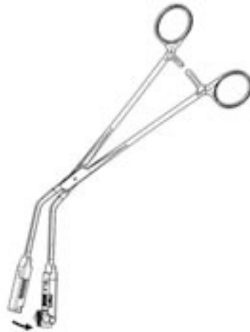
Fig. 2 Fermeture de la pince d'insertion
