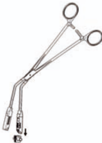
Рис. 1 Вставка упругого элемента в установочные щипцы
