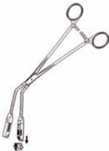
Fig. 1 Inserir o elemento de mola na pinça de inserção
