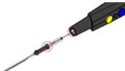
Fig. 5 Sticka in arbetselektroden i handtaget
