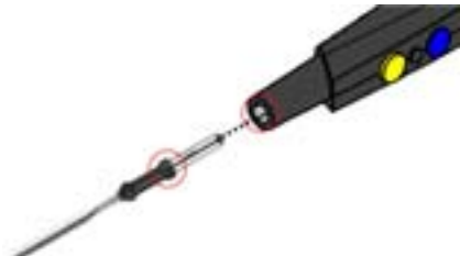
Obr. 5 Nasazení pracovní elektrody do rukojeti
