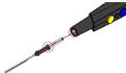
Fig. 5 Ficher l'électrode de travail dans la poignée
