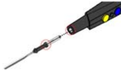
Afb. 5 Werkelektrode in handgreep steken
