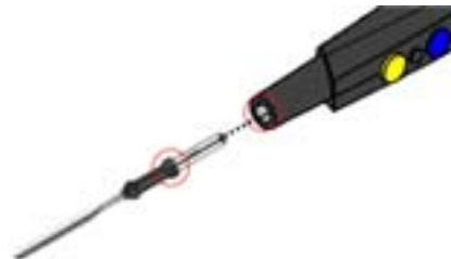
Fig. 5 Inserción del electrodo de trabajo en el mango
