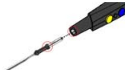
Rys. 5 Umieszczanie elektrody roboczej w uchwycie
