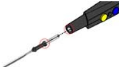
Abb. 5 Arbeitselektrode in Handgriff stecken
