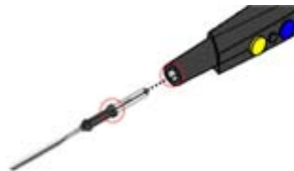
Fig. 5 Colocar os eléctrodos de trabalho no cabo
