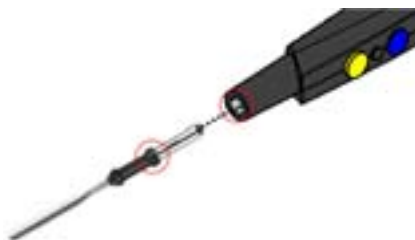
Fig. 5 Ficher l'électrode de travail dans la poignée
