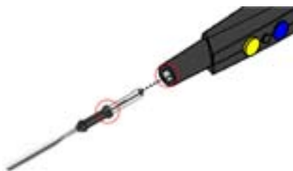
Fig. 5 Inserimento dell'elettrodo di lavoro nel manipolo
