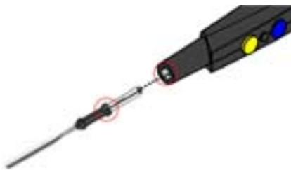
Abb. 5 Arbeitselektrode in Handgriff stecken
