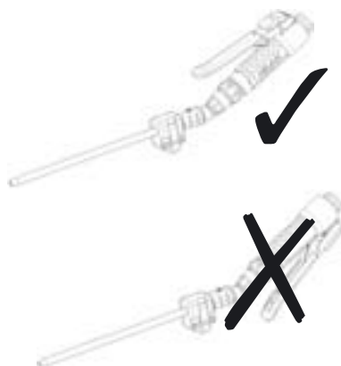
Fig. 2 Montaje del instrumento
