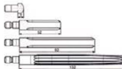
Die Gesamtlänge des Tibiaplateaus mit dem entsprechenden Verlängerungsschaft ergibt sich aus der Tibiakelllänge (Abmessung D) und der Verschlusschraube 7 mm oder der Schaftlänge 52 mm, 92 mm oder 132 mm.
