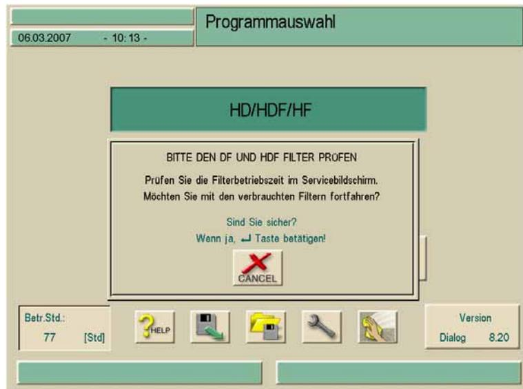
Fig. 8-10 Hinweisfenster „Filterwechsel“
