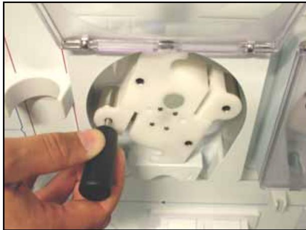
Fig. 13-2 Kurbel einsetzen (Variante 1)
