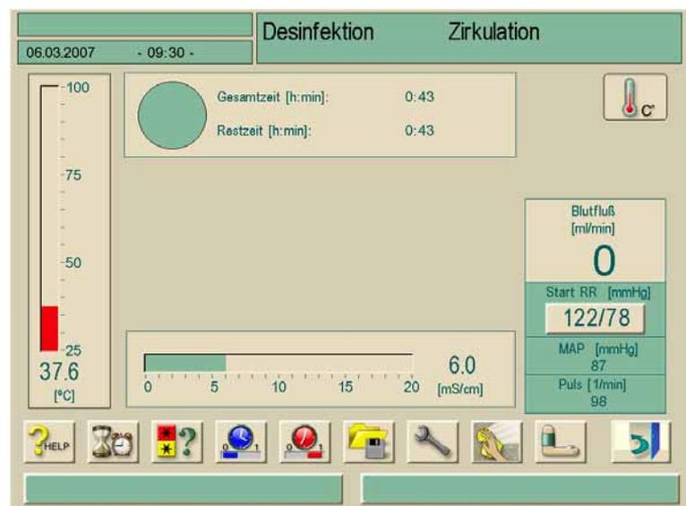
Fig. 7-5 Bildschirm „Thermische Desinfektion“
