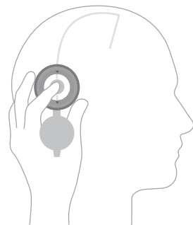
Fig. 11: localizzazione della valvola con la bussola M.blue plus
