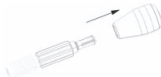
Fig. 8 Smontaggio dell'impugnatura punta a spirale
