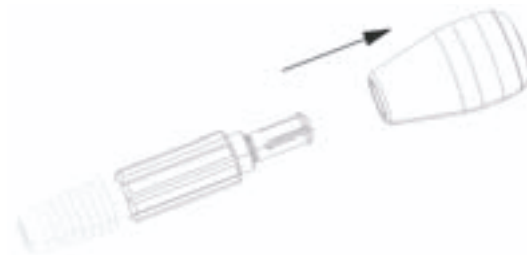
Abb. 8 Demontage des Bohrhandgriffs
