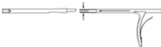
Obr. 13 Montáž zavádzača tyče
