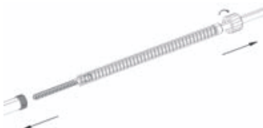
Fig. 9 Démontage des tarauds
