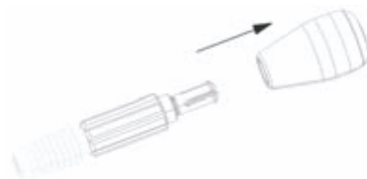
Fig. 8 Demontering av spiralborrshandtag
