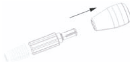
Obr. 8 Demontáž otočné rukojeti vrtáku
