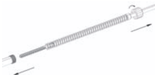
Abb. 9 Demontage von Gewindeschneidern
