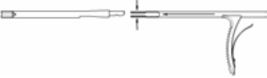
Şekil 13 Çubuk tabancasının birleştirilmesi
