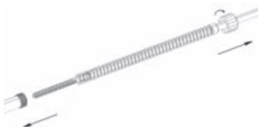
Fig. 9 Smontaggio dei maschi
