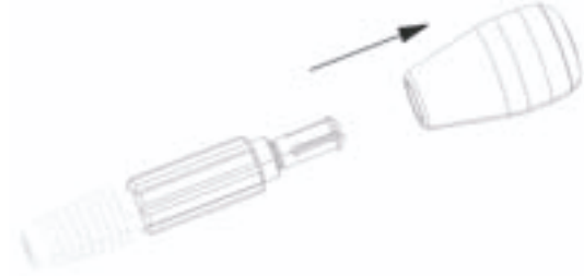
Şekil 8 Bükmeli delgi kolunun sökülmesi
