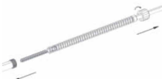
Fig. 9 Demontering av tappar
