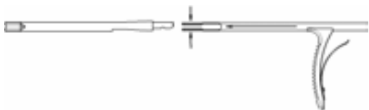
Fig. 13 Montage de l'outil à contraindre les tiges
