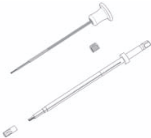
Fig. 10 Vista expandida da chave de parafusos poliaxiais com autorretenção S 4 Cervical
