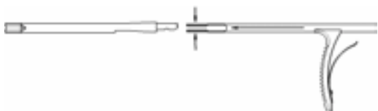
Fig. 13 Montaje del colocador de barras
