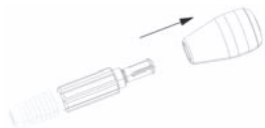
Рис. 8 Разборка рукоятки дрельбора
