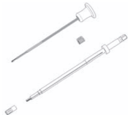
Fig. 10 Sprängskiss av S 4 cervical självhållande polyaxial skruvdragare
