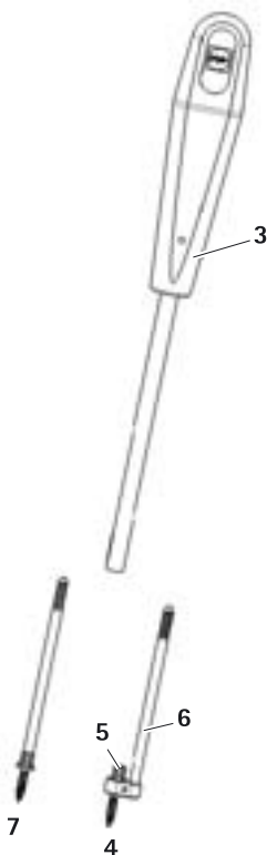
Fig. 1 Tournevis de distraction avec vis de distraction et vis de distraction offset
