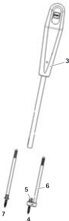
Fig. 1 Chave de parafusos com parafuso de distracção e parafuso de distracção offset
