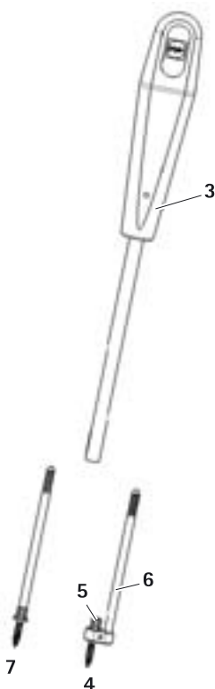
Fig. 1 Destornillador de distracción con tornillo de distracción y tornillo de distracción offset
