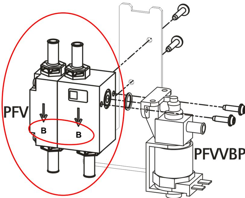
Abb. 1: PFV Gehäuse (modifiziertes Gehäuse am gravierten **B** erkennbar)
