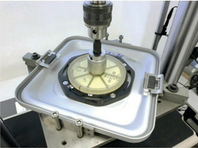
PRIMELine® PRO Deckel fixiert auf einer Maschinenspindel für das Ein- und Ausdrehen der Filterkassette.
