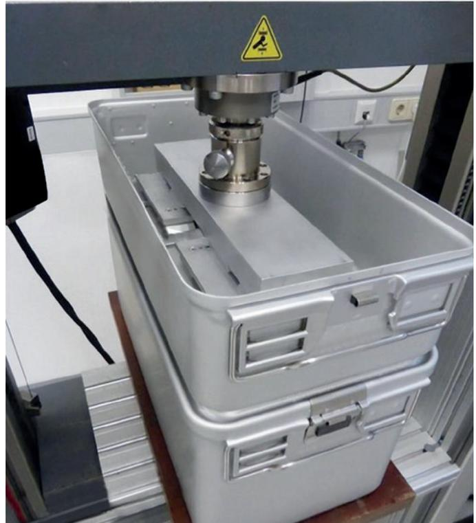
Mechanische Stapeldruckprüfung mit PRIMELine® PRO Containersystem.
