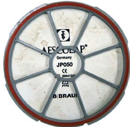
Verfärbte Filterscheibe, durch die Einflüsse der wiederholten Aufbereitung.
