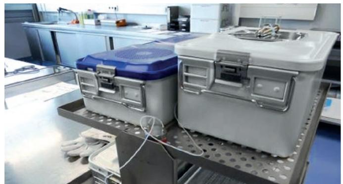
Positionierung von Thermoelementen zur Evaluierung der Sterilisierleistung von PRIMELine® PRO und Basis Containersystemen.
