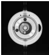
Fig. 17: Imagen radiográfica: la posición del rotor indica 13 cmH 2 O
