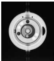
Abb. 17: Röntgenbild einer verstellbaren Differenzdruckeinheit, Stellung 13cmH 2 O
