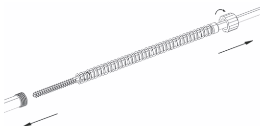
Fig. 9 Desmontaje de la terraja
