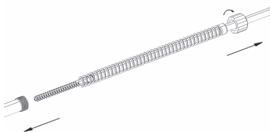
Fig. 9 Desmontagem de ferramentas para abrir roscas
