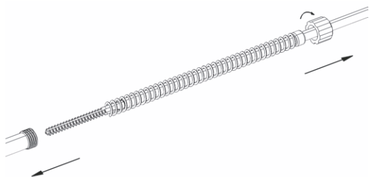
Kuva 9 Kairojen purkaminen osiin
