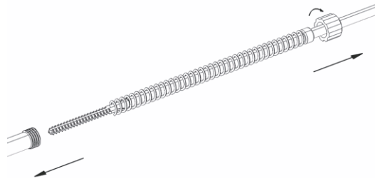
Fig. 9 Démontage des tarauds
