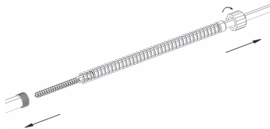
Abb. 9 Demontage von Gewindeschneidern
