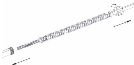
Fig. 9 Smontaggio dei maschi
