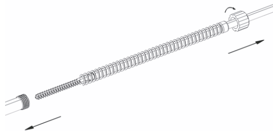
Fig. 9 Demontering av tappar
