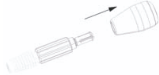
Şekil 8 Bükmeli delgi kolunun sökülmesi
