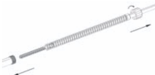
Fig. 9 Desmontagem de machos de parafusos
