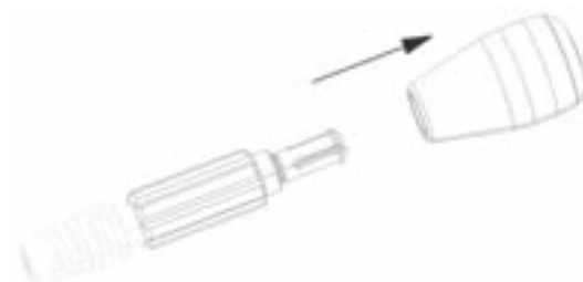
Fig. 8 Smontaggio dell'impugnatura punta a spirale
