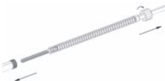
Fig. 9 Smontaggio dei maschi
