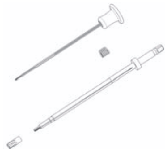
Fig. 10 Plano de despiece de destornillador poliaxial autosostenible S 4 Cervical
