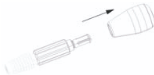
Afb. 8 Demontage van de draai-boorhandgreep
