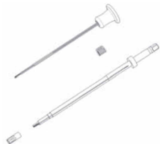
Rys. 10 Widok elementów składowych szyjnego samo-chwytnego wkrętaka wieloosiowego S 4
