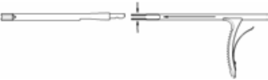
Şekil 13 Çubuk tabancasının birleştirilmesi
