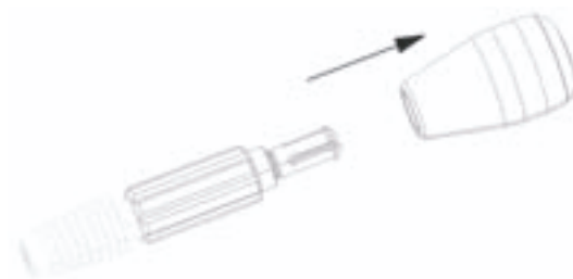
Fig. 8 Démontage de la poignée de perçage pour forets hélicoïdaux
