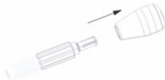
Fig. 8 Desmontagem do cabo de broca helicoidal
