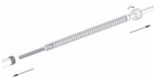
Afb. 9 Demontage van taps
