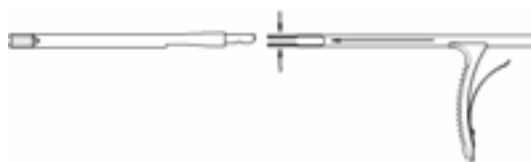
Рис. 13 Сборка устройства для вдавливания стержня
