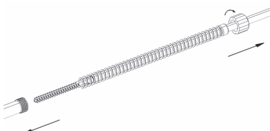
Fig. 9 Desmontagem de machos de parafusos
