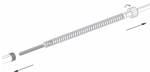
Afb. 9 Demontage van taps
