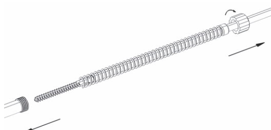
Fig. 9 Desmontaje de terraaja
