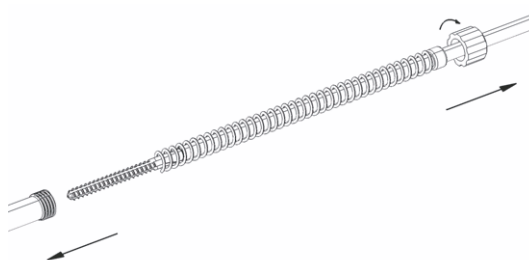
Fig. 9 Démontage des tarauds
