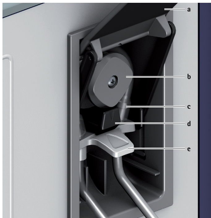
Fig. 4 Collegamento dei tubi monouso
