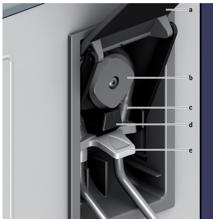
Rys. 4 Podłączanie zestawu drenów jednorazowych
