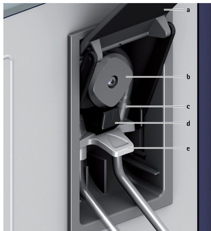
Obr. 4 Pripojte súpravu hadíc na jedno použitie
